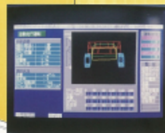
運転状況表示画面 ロボットの傾斜・走行・スクリュー位置等の状態を表示します。
